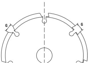
La largeur de l'interstice G entre les segments doit être au plus de 10 mm ( $\frac{3}{8}$ "). L'épaisseur du disque ne doit pas dépasser la valeur maximale de 3,5 mm ( $\frac{1}{8}$ ").
