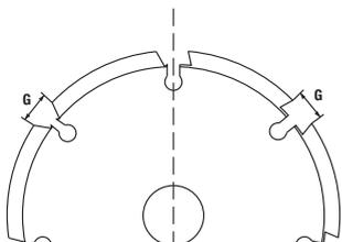
La anchura de la ranura G entre los segmentos no debe ser mayor de 10 mm ( $\frac{3}{8}$ "'). El grosor del disco no debe exceder el valor máximo de 3,5 mm ( $\frac{1}{8}$ "').
