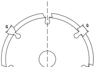
A largura da fenda, G, entre os segmentos não pode exceder os 10 mm (3/8"). A espessura do disco não pode exceder o valor máximo de 3,5 mm (1/8").
